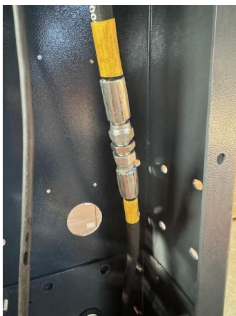
Fig. 17 - Tilslutning af olieslangen på begge stempler
