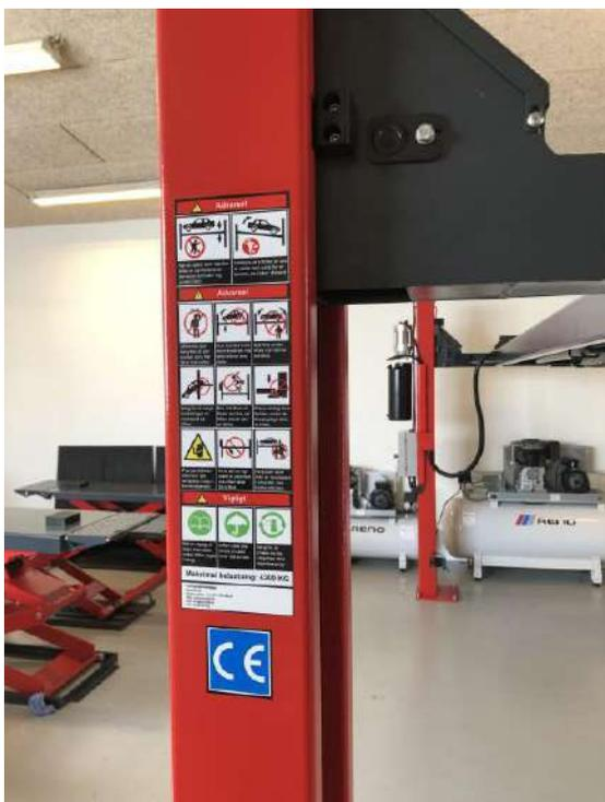
Fig. 1 - Placering af advarselsskilt på maskinen
